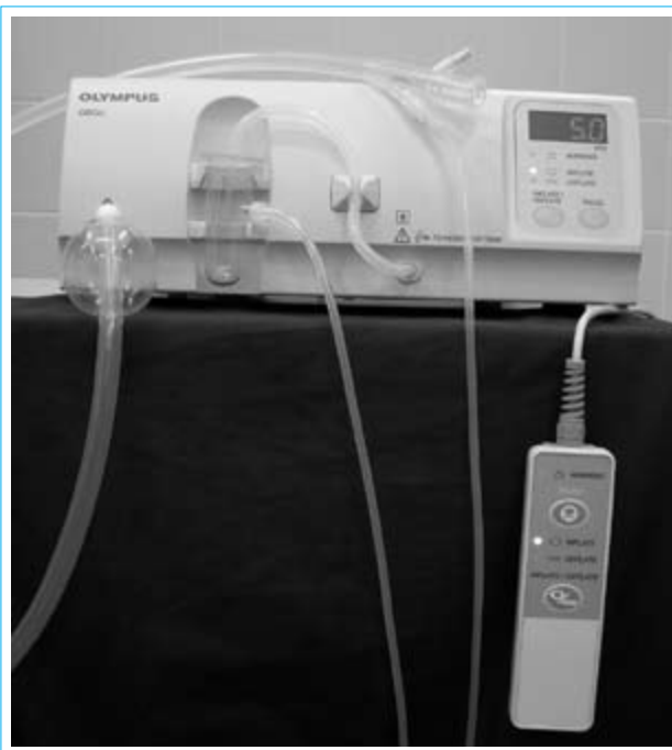
Рис. 3. Блок управления нагнетания воздуха в баллон (XMAJ-1725; «Olympus», Япония)
