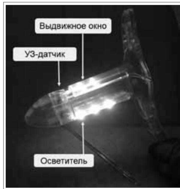
Рис. 1. Современный проктоскоп, разработанный ФГБУ «ГНЦК им. А.Н. Рыжих» совместно с ЗАО «БИОСС»
