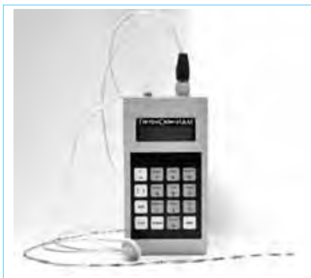
Рис. 4. Отечественный прибор импедансоацидомонитор «Гастроскан-ИАМ» (ТУ 9442-011-13306657-2011)
